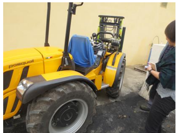
フォークリフト兼用トラクター (座席が180度回転するようになっている)
